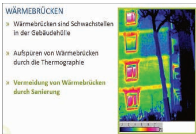
Darstellung von Wärmebrücken eines unsanierten Hauses.
